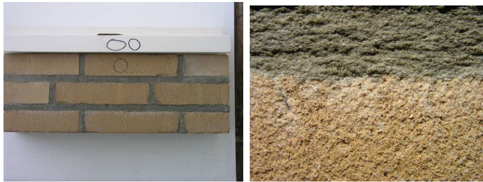
Figuur 2: Foto's gelakt kozijn na 120 cycli. Links kozijn met op een plaats een gebarsten verflaag, naar alle waarschijnlijkheid door een onregelmatigheid in het hout. Op de foto rechts een detailfoto van de lichte witte verkleuring van de baksteen.
