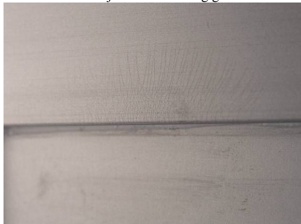
Figuur 3: Foto van microscopisch kleine barstjes in het geanodiseerde aluminium die tijdens de proef niet veranderden.
